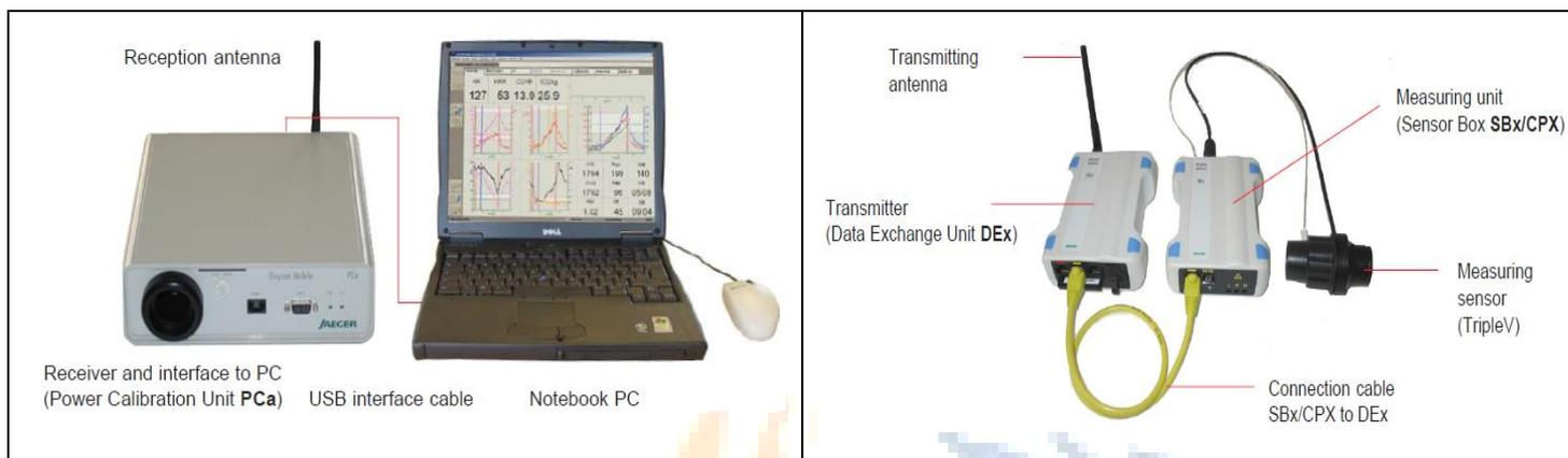
Figura 1. Exemplo de montagem do equipamento Oxycon Mobile.
