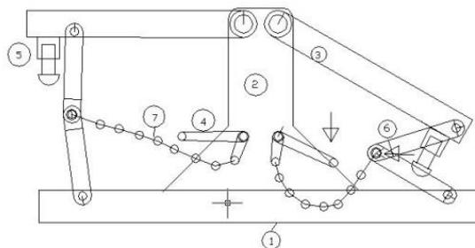
**Figura 1** - Esquema da plataforma simuladora de inversão e seus componentes, (1) base, (2) pilar central, (3) prancha móvel, (4) pedal, (5) batente, (6) extremidade da prancha, (7) corrente para tração.
