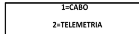
Digitando a tecla **1** o sistema estará habilitado a executar as coletas via cabo e digitando a tecla **2** o sistema estará habilitado a realizar as coletas via telemetria.
