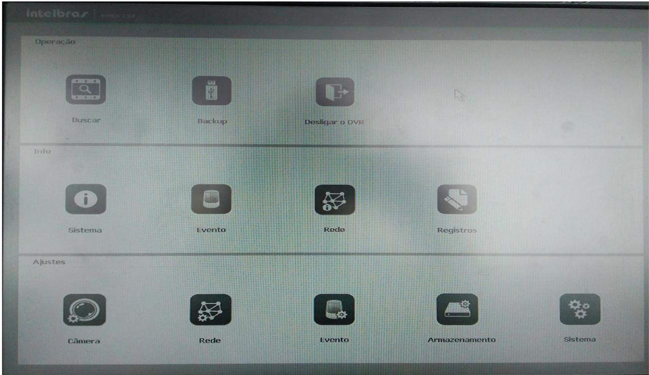
5 - Após o uso desligar o sistema via Menu Principal (Desligar o DVR), quando o sistema estiver desligado aparecerá uma mensagem no final da tela para desligar o cabo de alimentação. Então desligar o monitor, a fonte da câmera 1, o estabilizador e retirar o plug da tomada.
