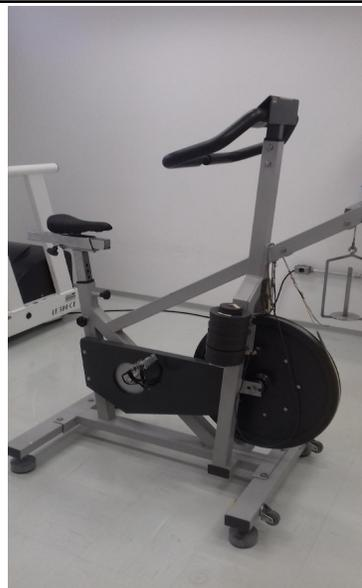
O cicloergômetro Biotec 1800 permite avaliar atletas de diferentes níveis de desempenho, bem como executar diferentes protocolos. Compatível com software para aquisição de dados de teste curtos ou longos (duração entre 1 a 3600 segundos), testes contínuos ou intermitentes com intervalos de tempo configuráveis.
