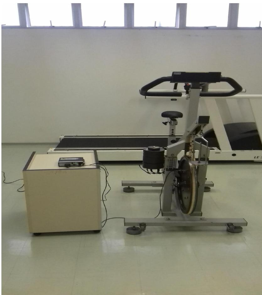
2) Verificar se o sensor foi identificado pelo coletor de dados. Na imagem abaixo, ao girar a roda do ergômetro a luz vermelha ascende ao passar pelos sensores, indicando que o sensor está conectado e funcionando corretamente.
